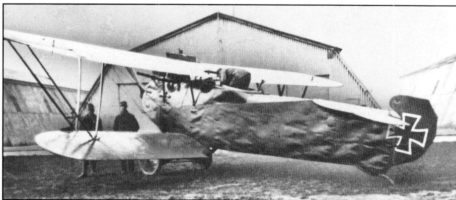
OBEN : Eine Aufnahme, die das Beulen der auf das Rumpfgestüt geleiteten Sperrholzbeplankung gut veranschaulicht.
